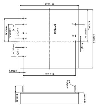
ALL DIMENSIONS IN INCHES(mm) PIN PITCH TOLERANCE  $\pm 0.014(0.35)$  Tolerance :  $x.xx\pm0.02(x.x\pm0.5)$   $x.xxx\pm0.01(x.xx\pm0.25)$
